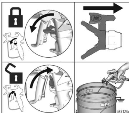
2. Поставьте курок на предохранитель. Верните распылительный наконечник в исходное положение. Выключите блокиратор пускового курка и продолжите распыление.
